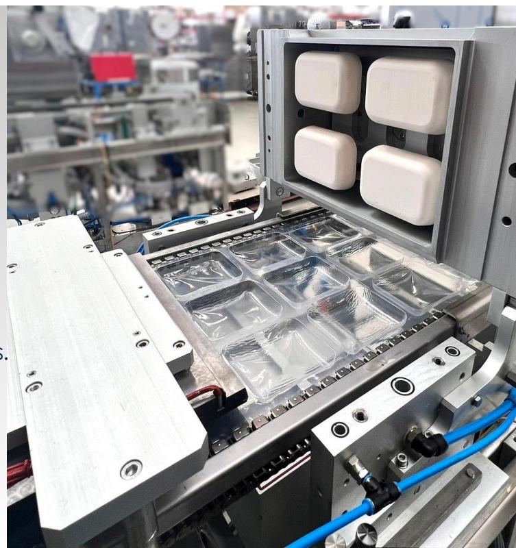
Les thermoformeuses horizontales Colimatic sont conçues pour le **conditionnement de produits alimentaires en grandes séries**. Elles offrent une flexibilité maximale grâce à leurs châssis modulaires, permettant de s'adapter à **divers types de produits et configurations de moules**. Un véritable atout pour les **productions de moyenne à grande échelle**, notamment dans les secteurs de la viande, des produits laitiers, des sauces ou des plats cuisinés.
